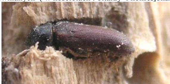
Fot. 24 Chrząszcz KOŁATEK UPARTY ( Anobium pertinax ) wygryza kanał o średnicy 2-3 mm w części bielastej drewna (powiększenie)
