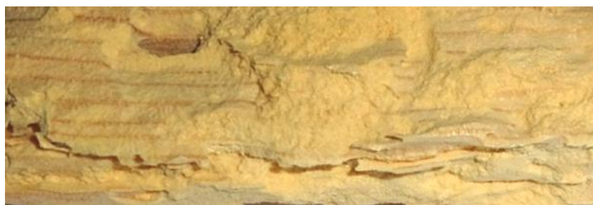
Fot. 23 Próbki pobrane z konstrukcji więźby dachowej uszkodzone przez Spuszczałę pospolitą ( Hylotrupes bajulus )
